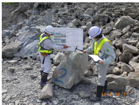
原石山材料判定 (CSG 材/コンクリート骨材)
